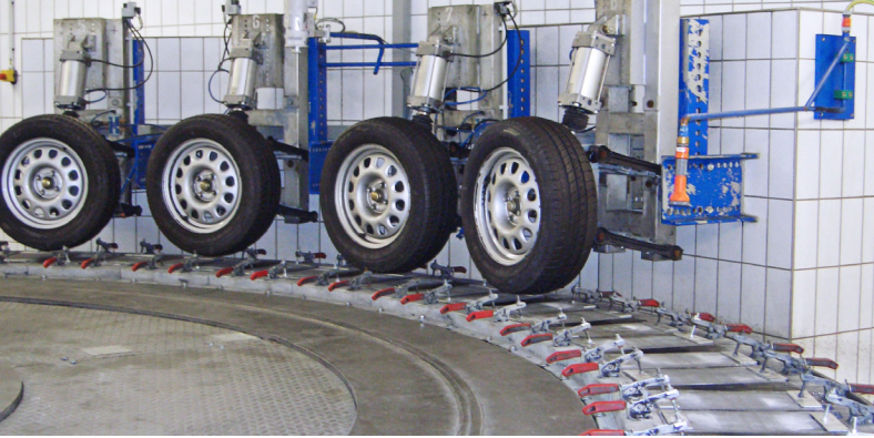
BASt Döner Tezgahlı Yol İşaretleme Testi Sistemi [ FOTO © Evonik Industries AG ]
