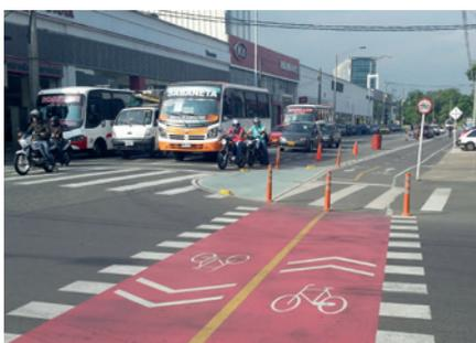
在大麦德林市区自行车道项目的选材问题上，有关部门希望找到一种极为耐用、能够承受日常通勤者带来的交通重负并且在干爽明媚的哥伦比亚环境中保持鲜艳色泽的材料，同时，这种材料必须适应都市中的柏油与混凝土路面。最终，他们在基于DEGAROUTE®的MMA道路标线系统中发现了完美的解决方案，该系统不仅完美满足他们的性能要求，并且人工或设备操作难度较小。“使用冷塑型产品
