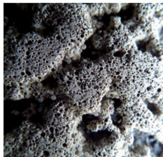
Даже после 5 лет эксплуатации холодные пластики на основе смол DEGAROUTE® соответствуют требованиям для разметки типа 2.
